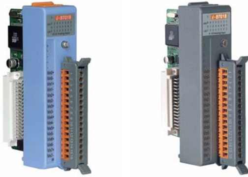
I-87018 I-87018-G 8-ch Thermocouple Input Module
