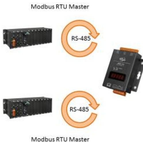
Дополнительно шлюзы MDC-700 позволяют организовать обмен данными между двумя Modbus RTU Master устройствами либо организовать опрос Modbus RTU Slave устройств сразу двумя Modbus RTU Master устройствами.
