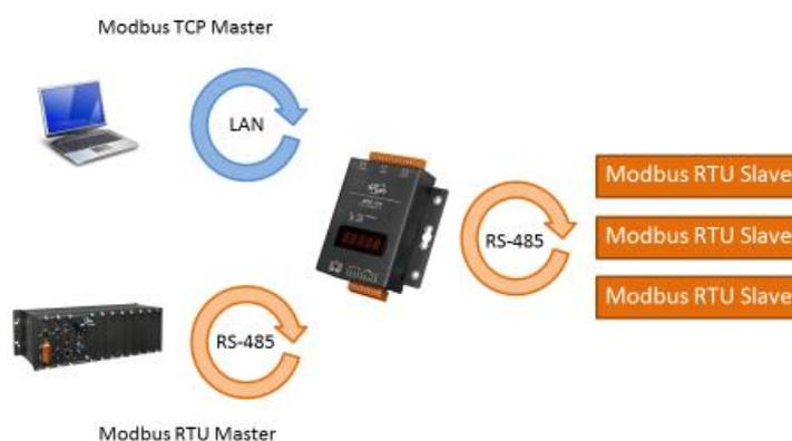
Шлюз периодически опрашивает Modbus RTU Slave устройства и сохраняет эти данные во внутренних регистрах. Одно или несколько Modbus Master устройств по протоколам Modbus RTU или Modbus TCP получают эти данные из памяти самого шлюза, а не из регистров конечных устройств.
